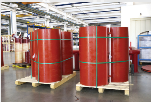
Катушки высокого напряжения
