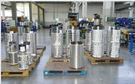
Заготовки обмоток высокого напряжения
